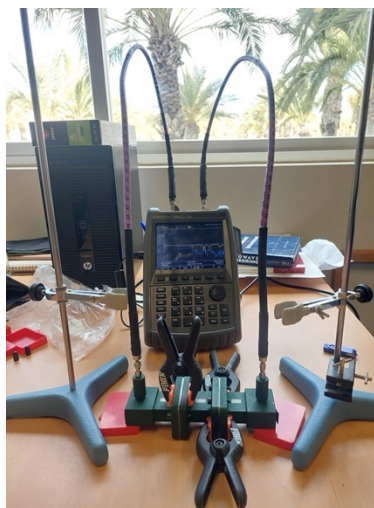
Figura 4. Set-up utilizado para la caracterización dieléctrica de diferentes materiales de impresión 3D analizados para la antena embebida. a) sonda coaxial acabada en abierto de Keysight. b) Método desarrollado por el grupo de investigación EMwLab basado en medidas de transmisión en guía de onda.
